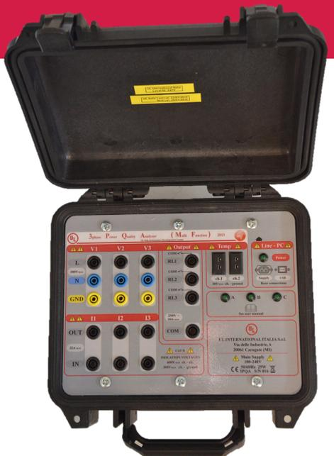
Sistema di acquisizione per l'analizzatore della qualità della rete
