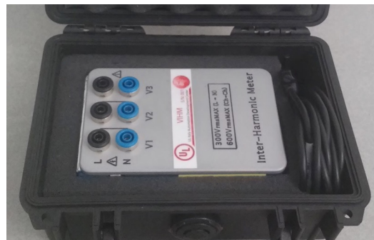
AUT HW 006 VIHM: Misuratore delle interarmoniche di tensione
