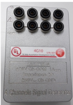
AUT HW 005 4G10: Generatore di segnali a 4 canali
